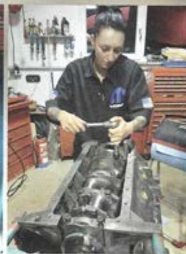
Einbau der neuen Pleuelwelle. Erst mal leicht anziehen ... danach kommt der Drehmoment-schlüssel zum Einsatz
