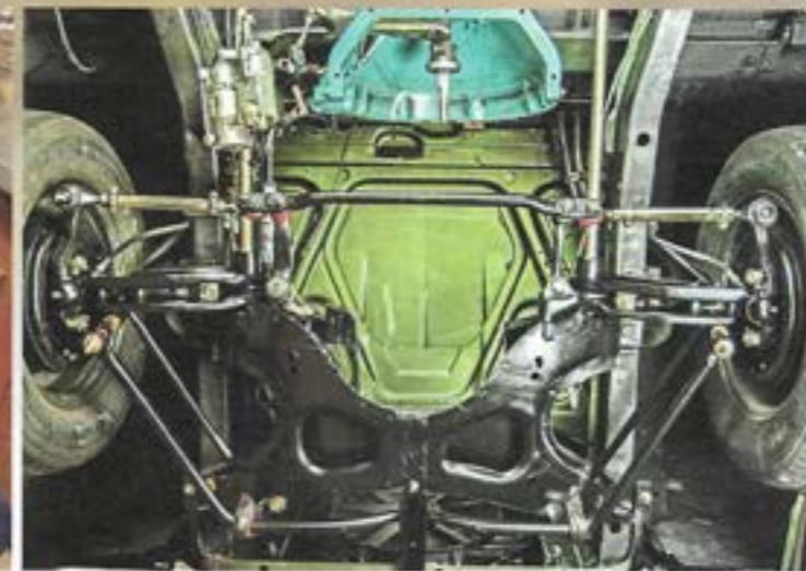
Die fertig zusammengebaute Vorderachse mit PU-Buchsen. Schön zu sehen ist hier der mit viel Liebe lackierte Motorraum/Motorhaube im originalen Farbton
